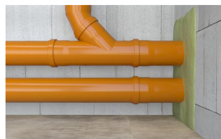
Riempimento di attraversamenti di tubazioni.
